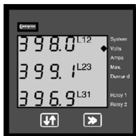
Display 5: Spannung Phase/Phase
