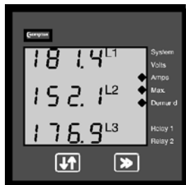
Display 5: Spannung Phase/Phase
