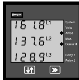
Display 4: Spannungen Phase/N (4-Leiter-System)
