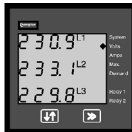
Display 4: Spannungen Phase/N (4-Leiter-System)
