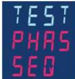
Mit dieser Funktion wird die Phasenfolge von Spannung und Strom angezeigt.
