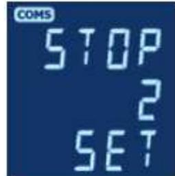
5. Mit der Taste
