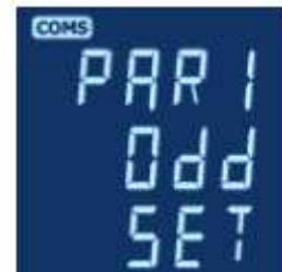
5. Mit der Taste
