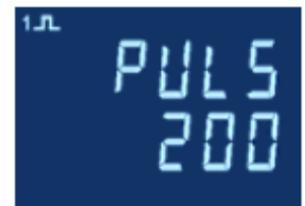
2. Durch Betätigung der Taste
