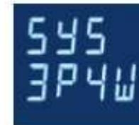
2. Mit Betätigung der Taste
