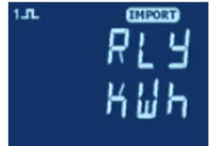
3. Durch erneutes Betätigen der Taste
