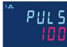
4. Der ausgewählte Wert wird mit der Taste
