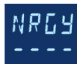
2. Mit Betätigung der Taste
