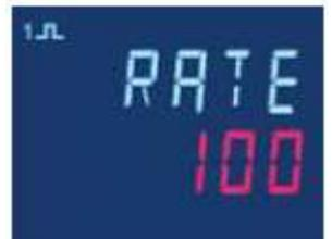
4. Der ausgewählte Wert wird durch betätigen der Taste
