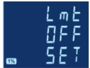
5. Mit der Taste
