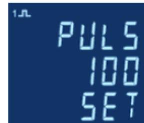
5. Mit der Taste
