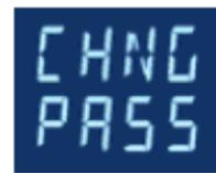
2. Mit Betätigung der Taste
