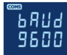
2. Mit der Taste
