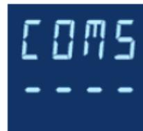
2. Bei Betätigung der Taste
