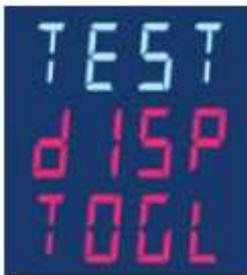
Mit dieser Funktion blinken unterschiedliche Segmente der Anzeige im Wechsel auf.
