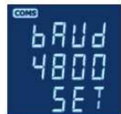
5. Mit der Taste
