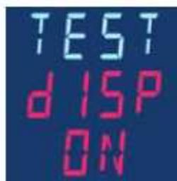
Bei dieser Funktion werden alle Segmente des Displays eingeschaltet.
