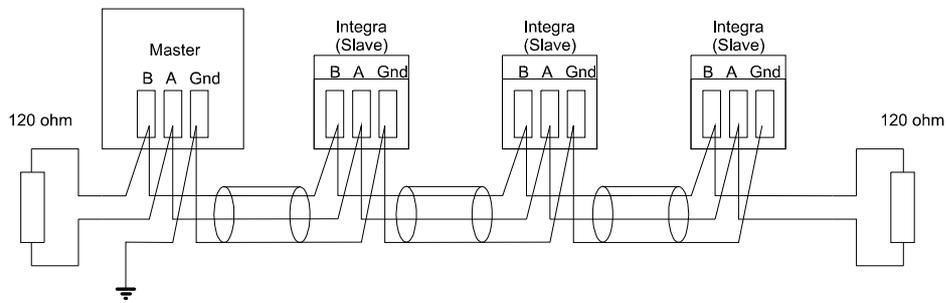
An jedem Anschluss dürfen nicht mehr als 2 Adern angeschlossen werden. Dies stellt eine geradlinige Verdrahtung zur Vermeidung von Reflektionen und der daraus resultierenden mangelhaften Datenübertragung, wie sie bei Stern- oder Abzweigverdrahtungen auftreten können, sicher.
